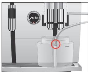
► Placez le récipient sous l'écoulement combiné et reliez le tuyau de lait au récipient.
