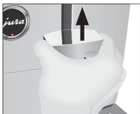
► Appuyez sur les dispositifs de déblocage et retirez le couvercle de l'écoulement combiné par le haut.
